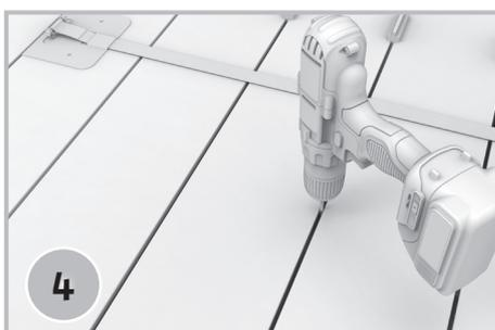
Nach 5-6 Dielen ziehen Sie die Clips mittels Schraube und mit mittlerem Drehmoment nach.
