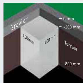
Des fondations appropriées à part sont nécessaires. Pour ce faire, creuser tous les trous des fondations (400 x 400 x 800 mm) et les remplir de béton coulé de -800 mm à -200 mm. Laisser durcir entièrement. En alternative, il faudra réaliser un système d'encrage approprié.
