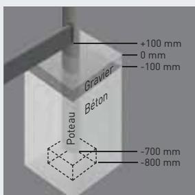
Remplir les premiers 100 mm du trou de fondation avec du béton coulé. Placer le cadre à une profondeur de -700 mm dans le trou de fondation. Caler le bord inférieur du poteau avec exactitude à l'aide d'une petite brique de construction. Remplir le trou de fondation jusqu'à -100 mm avec du béton coulé. Tous les poteaux doivent être parfaitement verticaux.
