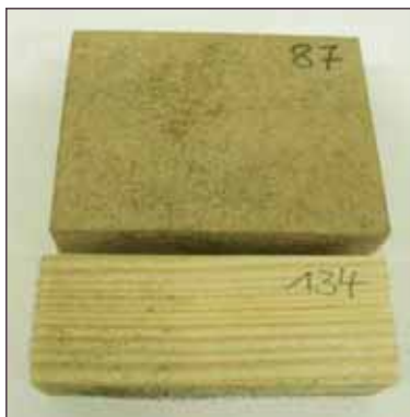
Abb. 4: Referenz-Prüfkörper nach der Schimmelpilzprüfung: Bewuchs deutlich erkennbar (oben: MDF, unten: Kiefernspint).
