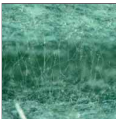
Abb. 7: Schimmelpilze auf PK 59 (H40), 40-fache Vergrößerung.
