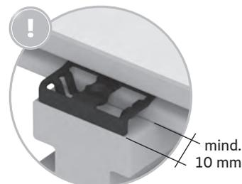
Randclip bündig zum Konstruktionsbalken setzen.
